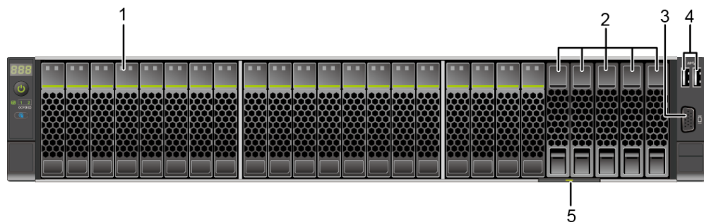
图3-3 8x2.5 SAS/SATA+12x2.5 NVMe 硬盘配置前面板组件
